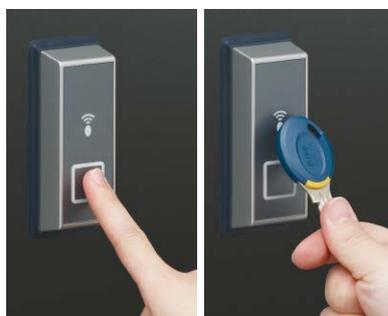
①リーダのボタンを押し、IDキーヘッド(タグ)をリーダ部に接触させます。
